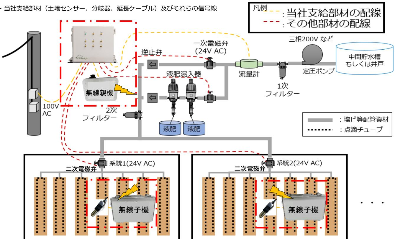
■ 制御盤本体 簡易接続図 ※オレンジ色の線はカスタム注文時のみ付属します、詳細はお問い合わせください。
